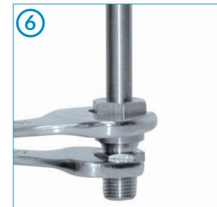
**6** Con l'ausilio di una chiave effettuare il serraggio finale del dado sul tubo avitandolo di circa  $\frac{3}{4}$  - 1 giro a seconda della dimensione del raccordo utilizzato, controllando che il tubo non giri insieme al dado. Si consiglia di utilizzare una chiave dinamometrica e far riferimento alle coppie di serraggio indicate in tabella.
