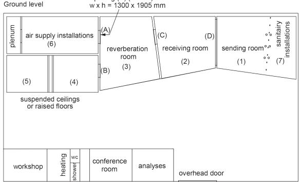
TEST OPENINGS (w x h in mm)
