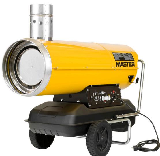
**Generatore d'aria calda Indiretto canalizzabile. Aria in uscita del generatore completamente pulita, priva di odori o fumi grazie alla separazione tra la camera di combustione e quella di scambio del calore.**
