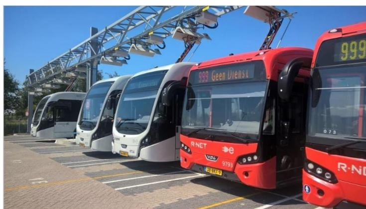
*Rechargement par pantographe ascendant dans un dépôt de bus © DR*
