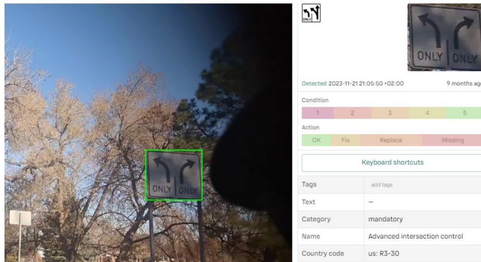
Le système identifie automatiquement les panneaux de signalisation, les ajoute à la base de données d'inventaire et détecte les panneaux manquants.
